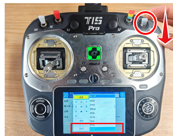
5. Виберіть CH11 6. Призначте SB 7. Підтвердьте й поверніться 8. Перевірте SB у списку
