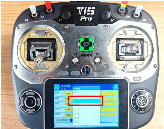
5. Виберіть CH11 6. Призначте SB 7. Підтвердьте й поверніться 8. Перевірте SB у списку
