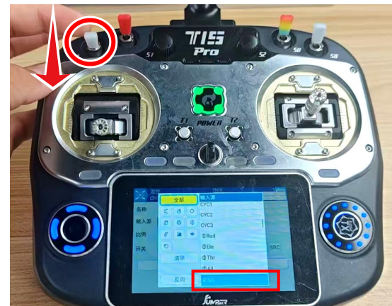
5. Виберіть CH10 6. Призначте SA 7. Підтвердьте й поверніться 8. Перевірте SA у списку
