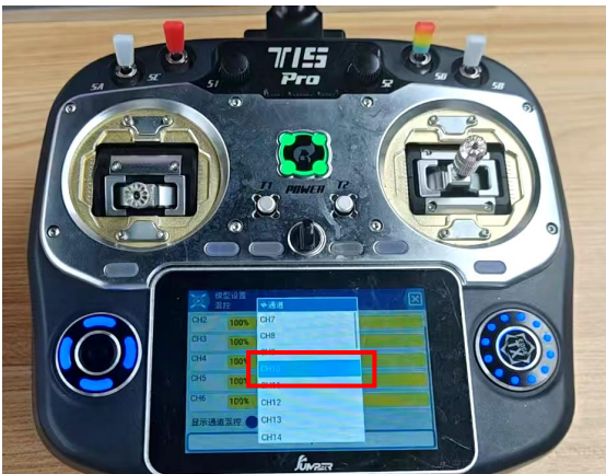
5. Виберіть CH10 6. Призначте SA 7. Підтвердьте й поверніться 8. Перевірте SA у списку
